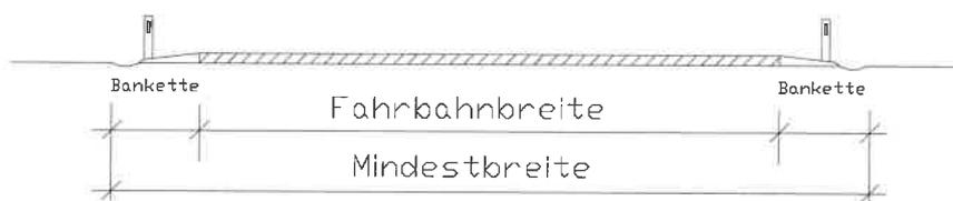
Die Mindestbreite der Straße errechnet sich aus Fahrbahnbreite (z.B. Asphaltband) inkl. Bankett. Erforderliche Böschungflächen verbleiben demnach innerhalb des Baugrundstückes.
